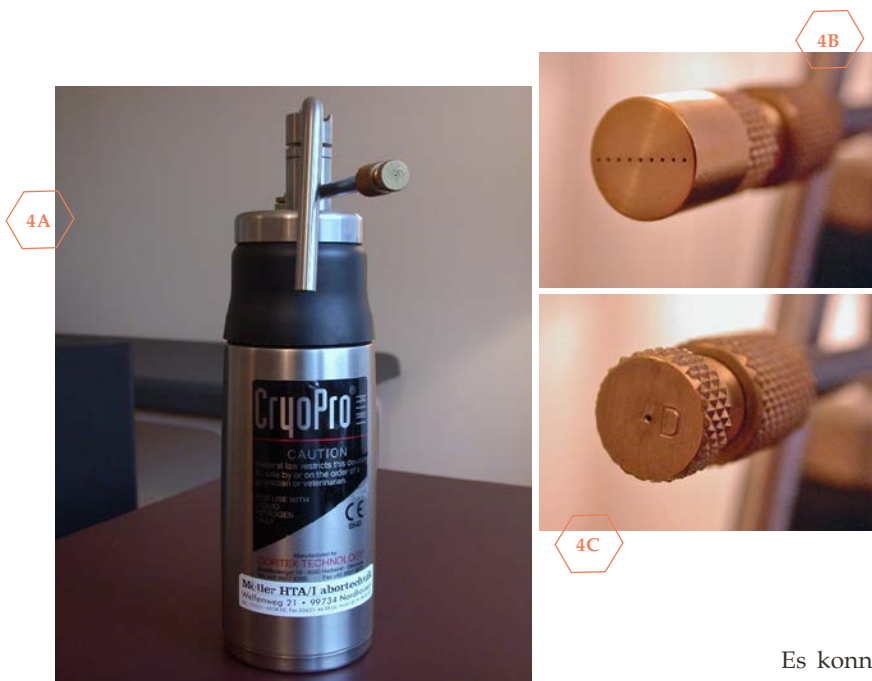
[ABB. 4] Die Kryotherapie-Einheit mit A) Spraybehälter für den flüssigen Stickstoff, B) der kleinsten Düsenöffnung D sowie C) der speziellen 10-Loch-Düse zur Vermeidung von postinterventionellen Blasenbildungen
